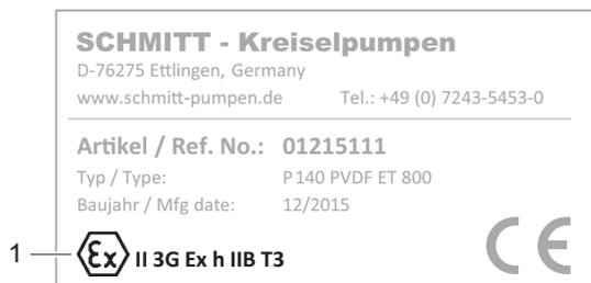
Abb. 2 Typenschild ATEX (Beispiel)
