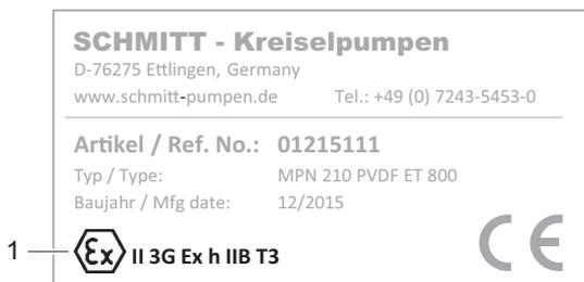
Abb. 2 Typenschild ATEX (Beispiel)
